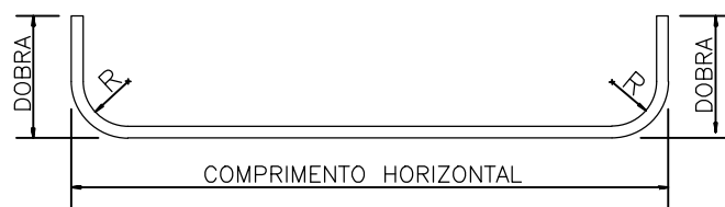
DETALHE DO RAIO DE DOBRAMENTO DOS FERROS
